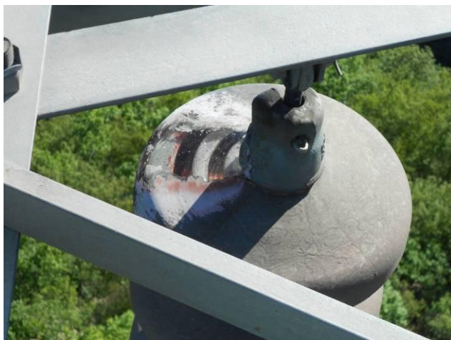
图 X XXXX（放电痕迹的局部清晰照片）（样图）
