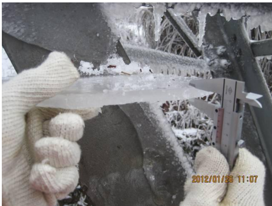
图 X XXXX (现场天气情况说明照片，导线脱落覆冰照片)
