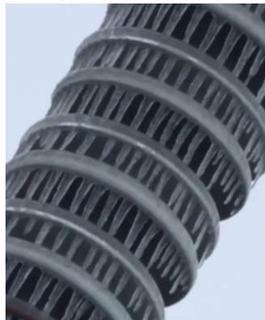
图 X 绝缘子串覆冰桥接程度比例（样图）
