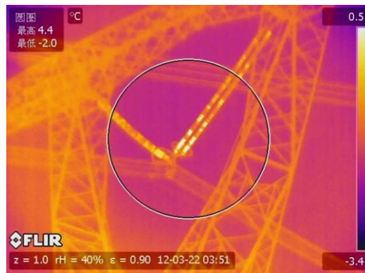
图 X 绝缘子串红外测温情况（样图）
