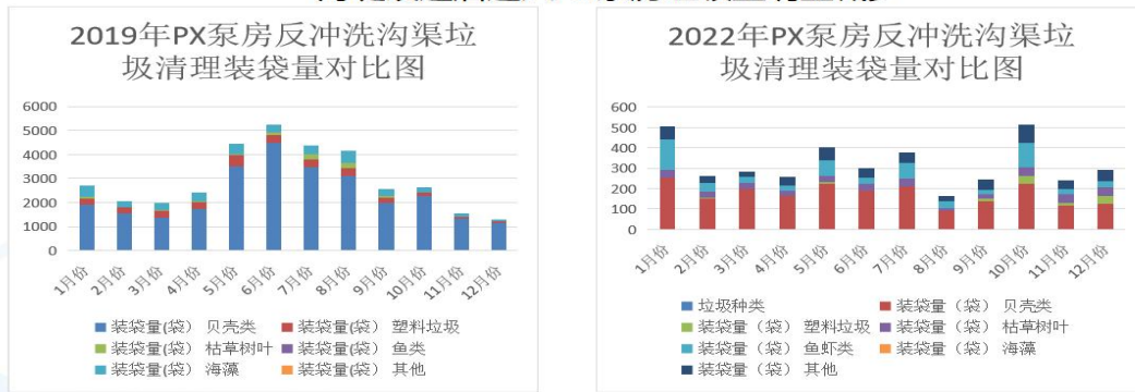
海堤改造后进入PX泵房垃圾量明显减少
