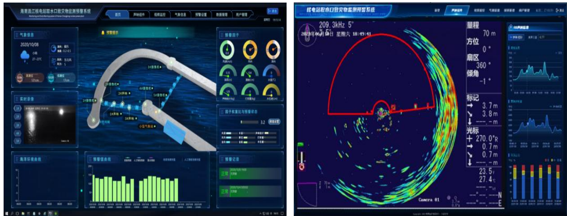
图5 取水口堵塞物监测预警系统（左：监测预警首页；右：声呐扫描）
