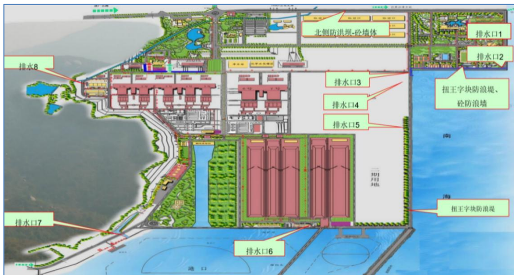
图 3 国能台山电厂厂区防洪设施示意图
