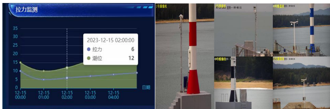
图 12 堵塞物监测预警系统（左：拦污网受力监测；右：视频监控）
