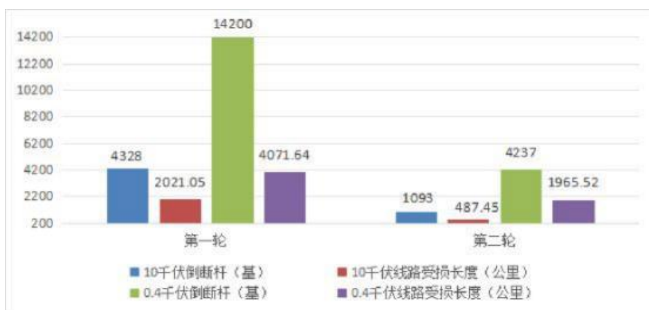
图 5 2024 年两轮雨雪冰冻灾害配网设备受损情况
