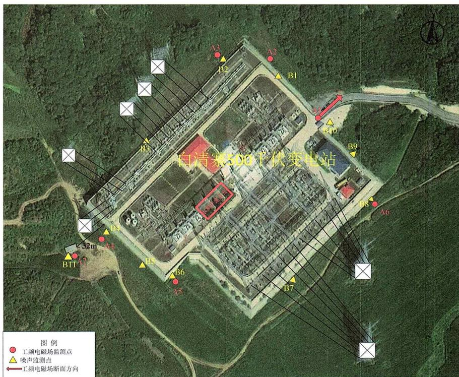
图 1 白清寨 500kV 变电站厂界及周边检测布点图
