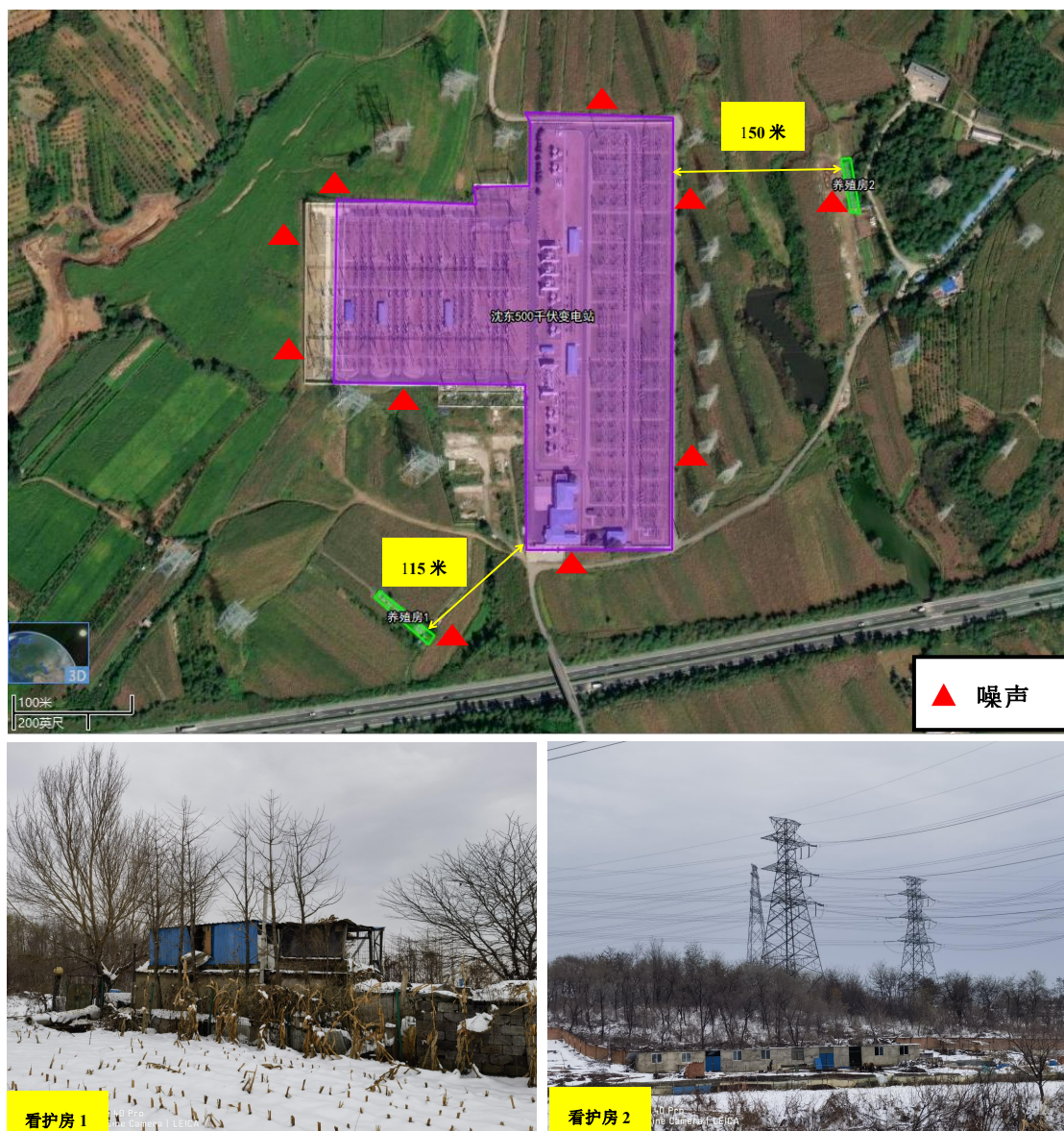
图 8-1 沈东变电站厂界及周围声环境敏感目标监测点位示意图
