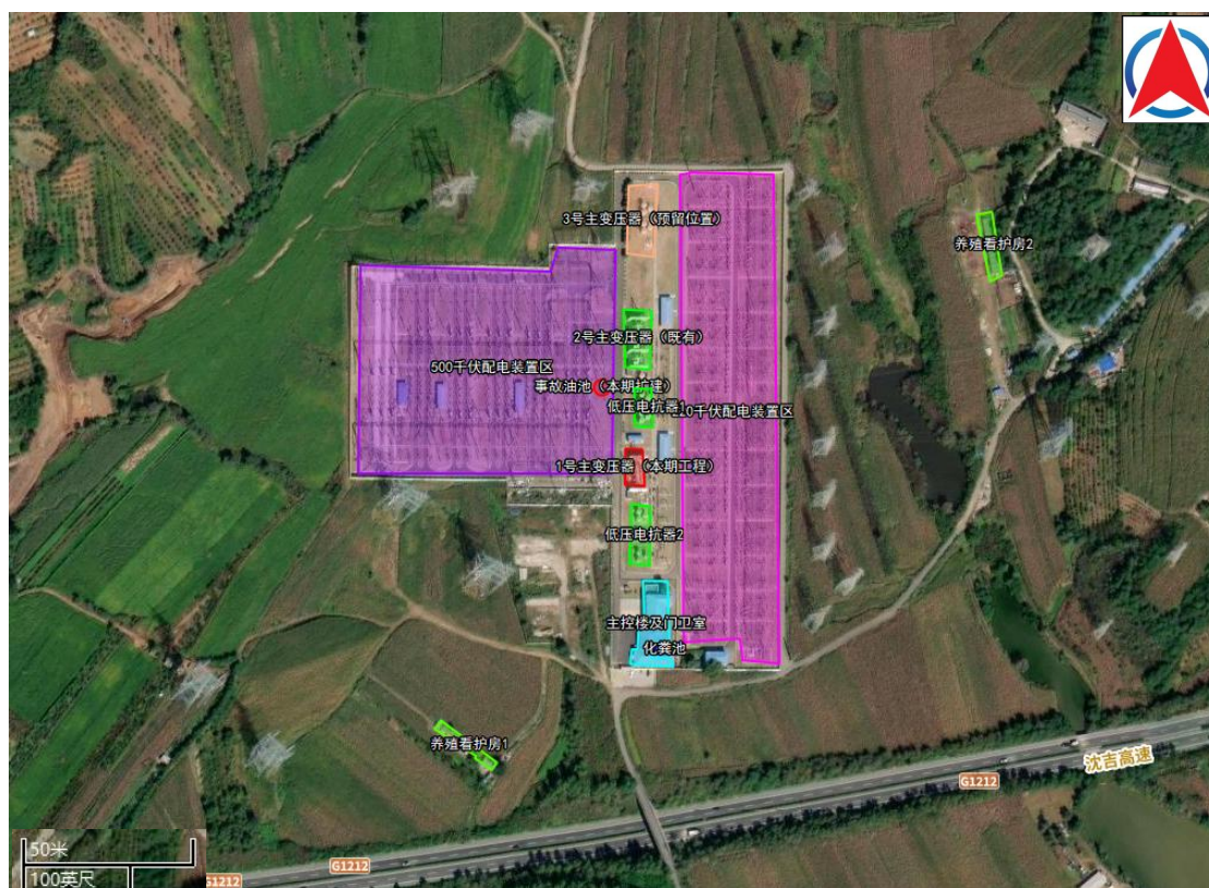
图 3-6 沈东变电站总平面布置示意图
