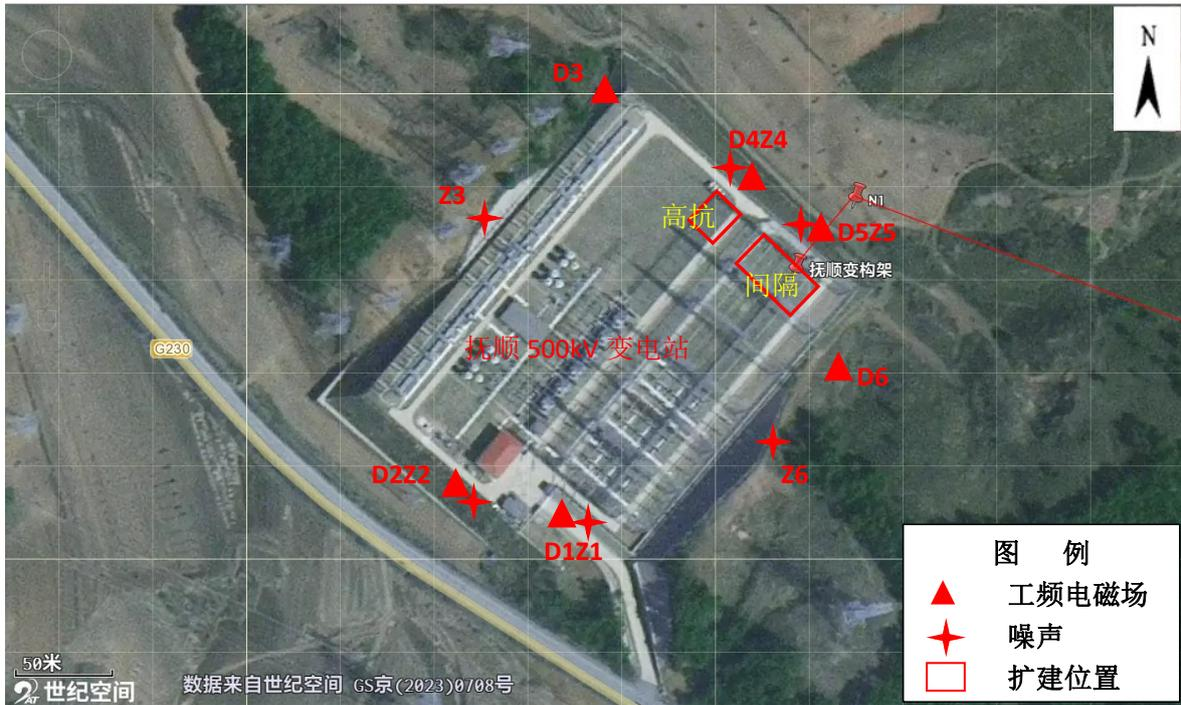
图 7-1 监测点位图（抚顺变电站厂界）
