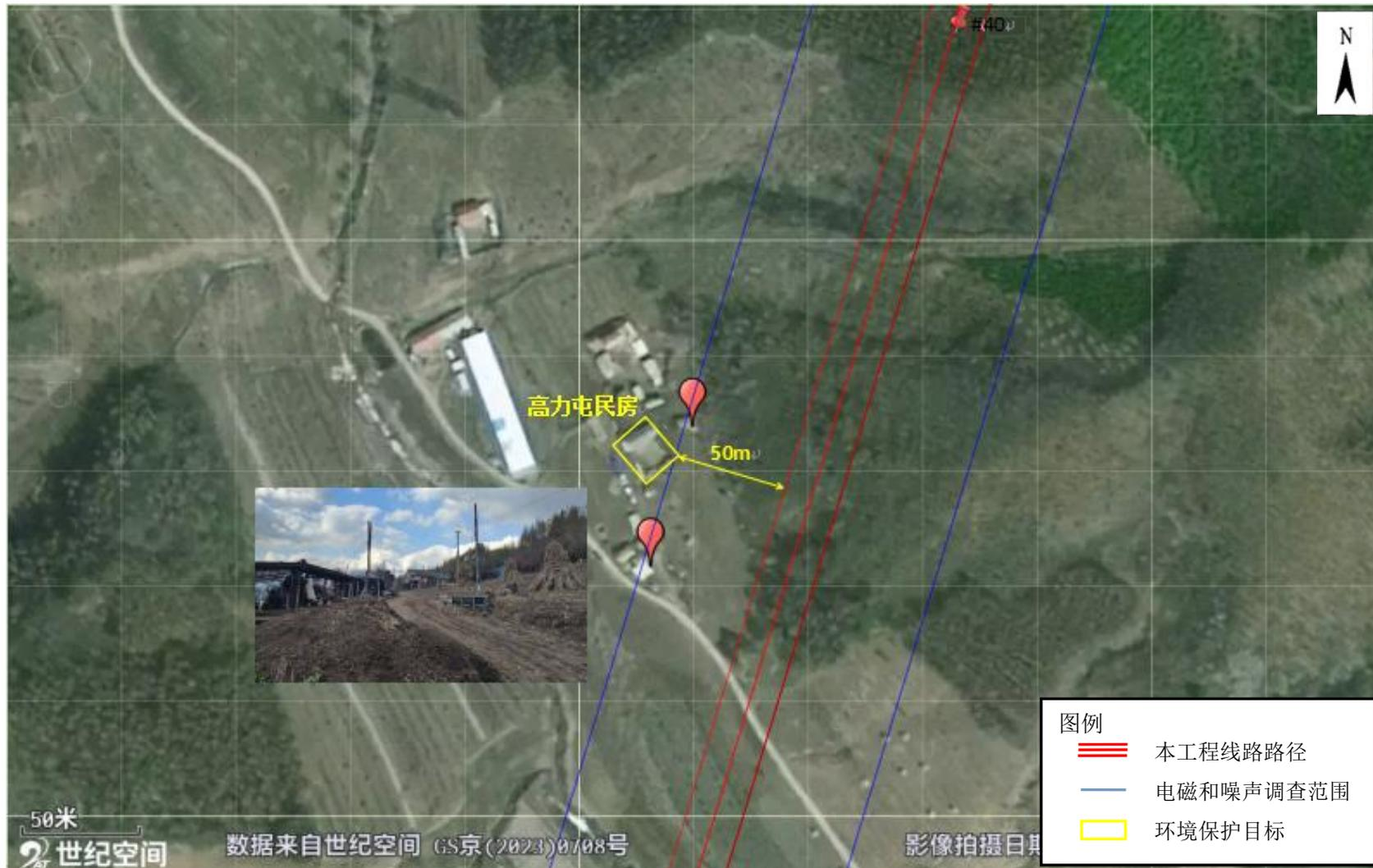
图 2-17 输电线路与高力屯民房位置关系图
